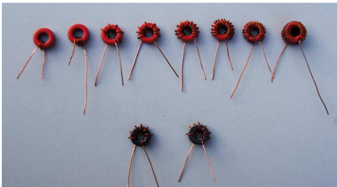
Fot.22. Cewki obwodu strojącego (sieci L) oraz cewki sprzęgacza pomiarowego.
