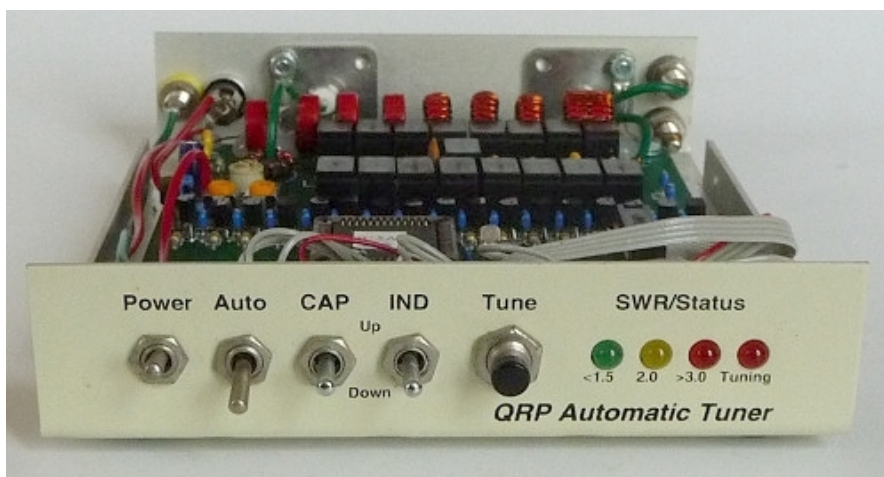
Fot.3. Widok automatycznego tunera antenowego LDG11-QRP.
