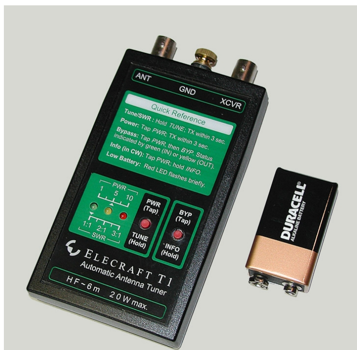
Fot.8. Automatyczny tuner antenowy QRP T1 Elecraft.
